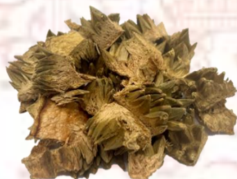
ภาพที่ 3-3 เปลือกทุเรียน (a) ขนาดประมาณ 5×5 เซนติเมตร (b) ขนาดอนุภาค 250 ไมโครเมตร
