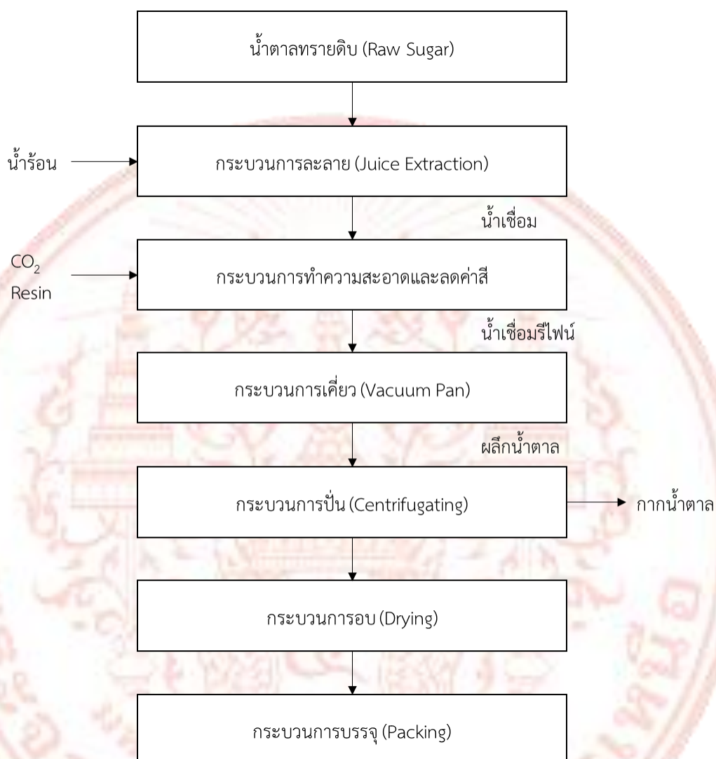
ภาพที่ 3-3 กระบวนการผลิตน้ำตาลทรายขาว และน้ำตาลทรายขาวบริสุทธิ์
