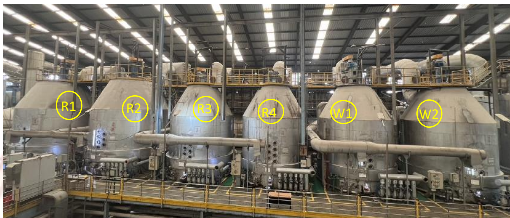
ภาพที่ 4-4 แผนภาพแสดงลักษณะและที่ตั้งหม้อเคี้ยว (Vacuum Pan)
