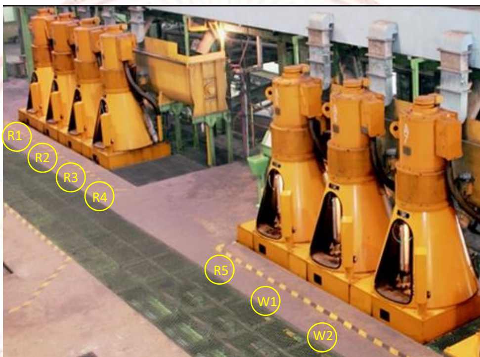
ภาพที่ 4-5 แผนภาพแสดงลักษณะและตำแหน่งติดตั้งหม้อป่น (Centrifugal)
