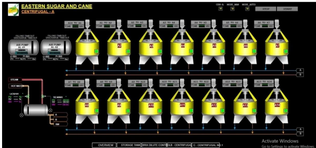
ภาพที่ 3-8 แสดงขั้นตอนกระบวนการปั่นแยกผลึกน้ำตาล (Centrifugal)
