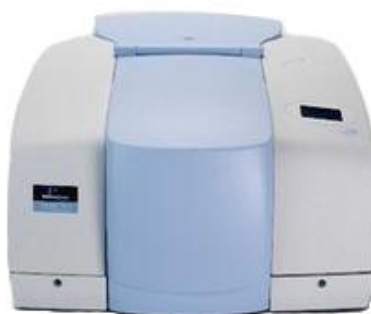
ภาพที่ 3.6 เครื่องวิเคราะห์สารโดยใช้แสงอินฟราเรด (Fourier Transform Infrared Spectrometer, FTIR)
