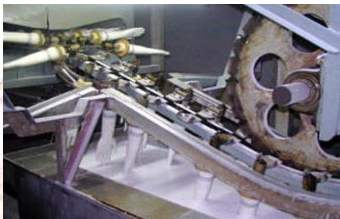
ภาพที่ 2-4 การจุ่มแบบมือลงในถังน้ำยาง
