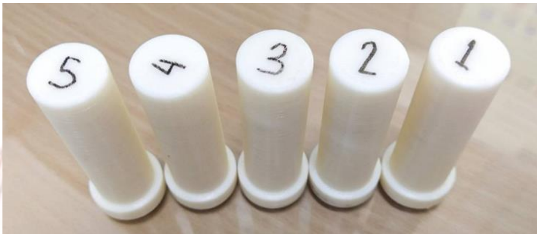
ภาพที่ 3-33 ลักษณะชิ้นส่วนทดสอบ ABS ที่พิมพ์ตามค่าพารามิเตอร์เริ่มต้นทั้งหมด 5 ชิ้น
