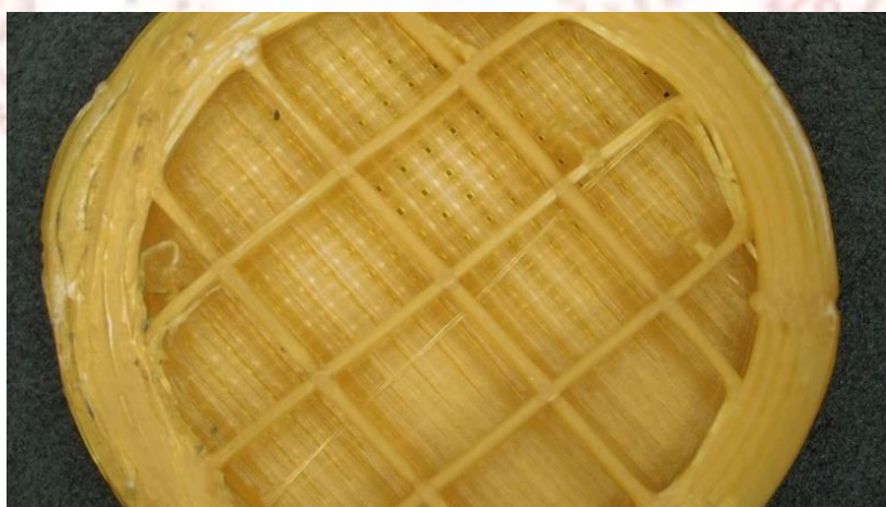
ภาพที่ 3-11 ลักษณะของพารามิเตอร์โครงสร้างภายในแบบตาราง (Grid)
