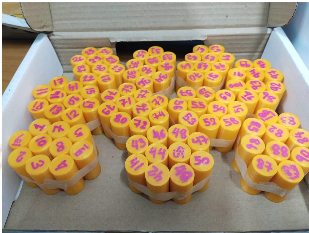
ภาพที่ 3-14 ตัวอย่างชิ้นส่วนทดสอบที่ 1 (PLA)
