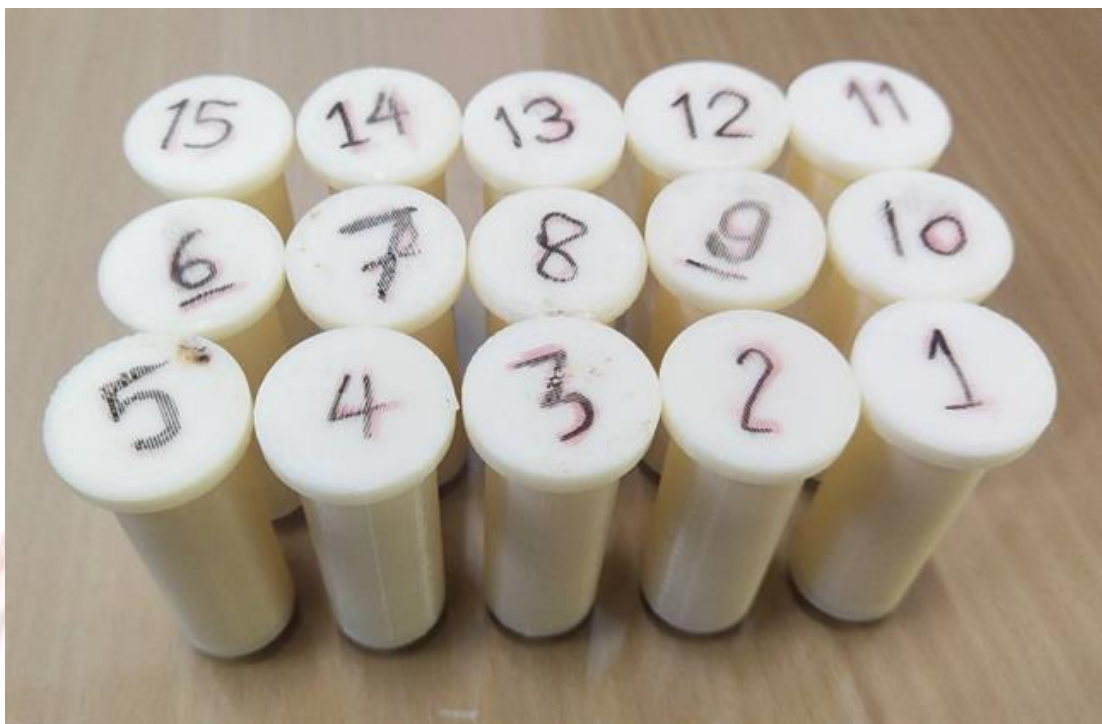
ภาพที่ 3-35 ตัวอย่างชิ้นส่วนทดสอบ ABS ทั้งหมด 15 ชิ้น
