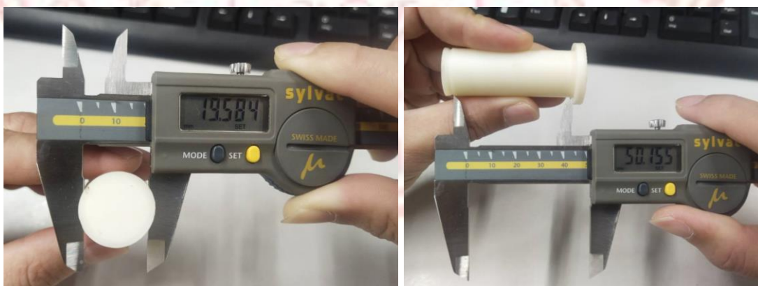
ภาพที่ 3-36 ตัวอย่างการวัดชิ้นส่วนด้วยเวอร์เนียคาลิเปอร์ รุ่น Sylvac S-Cal PRO
