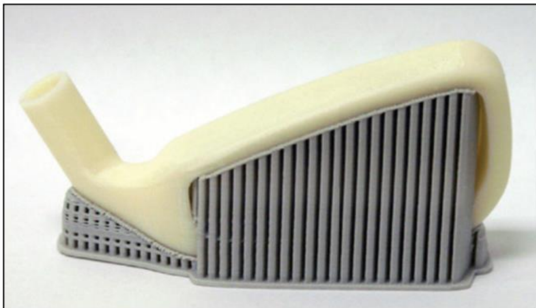
ภาพที่ 2-4 ลักษณะชิ้นส่วนที่ถูกพิมพ์ด้วยกระบวนการ และวัสดุรองรับส่วนโครงสร้าง (Przemysław Sieminski, 2021)
