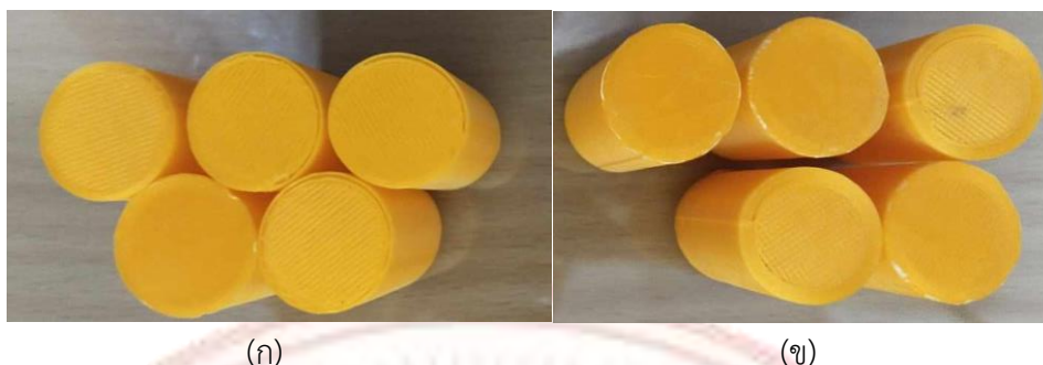
ภาพที่ 3-25 ตัวอย่างชิ้นส่วนทดสอบที่พิมพ์ด้วย (ก) ค่าพารามิเตอร์ที่เหมาะสมตามผลการวิเคราะห์ และ (ข) ค่าพารามิเตอร์เริ่มต้นโดย โปรแกรม Ultimaker Cura
