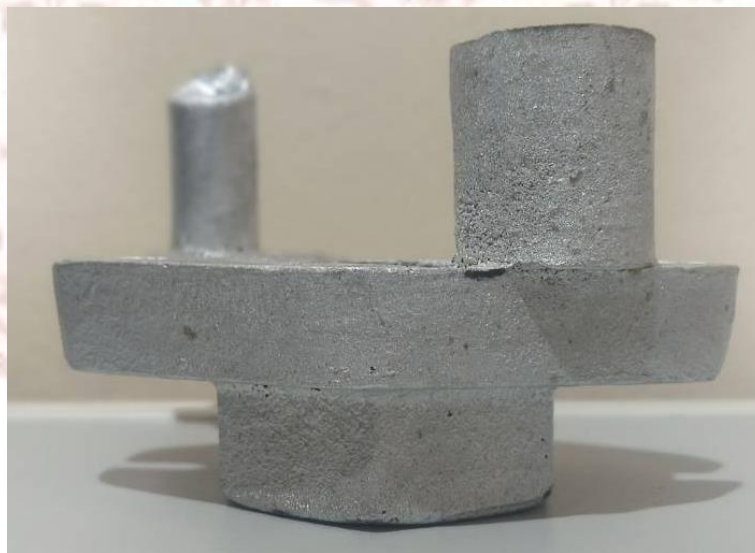
ภาพที่ 4-55 แสดงงานเทหล่อจริงของชิ้นงาน Cylinder_Q4 Riser (Front View)
