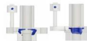
รูปที่ 8 แบบจำลองการเกิดโพรงหดตัวของชิ้นงานรูต้นทรงกระบอกกลางหนา 8 มิลลิเมตร (shrinkage porosity = 1.925 %)
