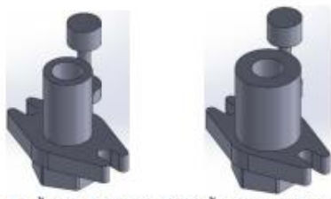
(ก) รูต้นทรงกระบอกกลางหนา 8 มิลลิเมตร (ข) รูต้นทรงกระบอกกลางหนา 15 มิลลิเมตร
