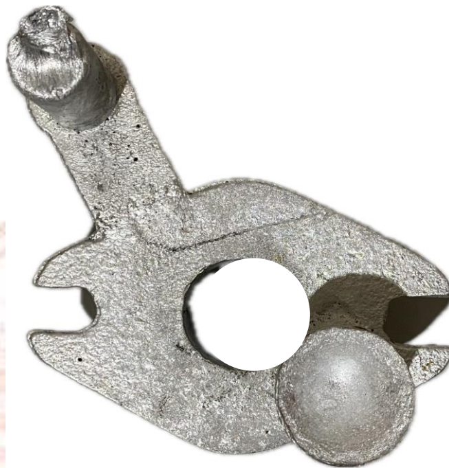
ภาพที่ 4-54 แสดงงานเทหล่อจริงของชิ้นงาน Cylinder_Q4 Riser (Top View)
