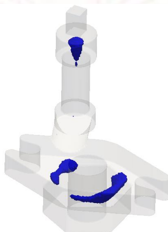
ภาพที่ 3-17 แสดงตำแหน่งของโครงหดตัวที่เกิดขึ้นภายในชิ้นงาน
