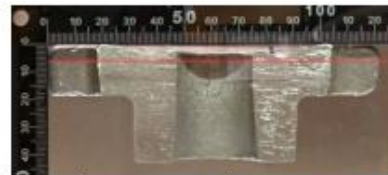
รูปที่ 4 การผ่าชิ้นงานหล่อจริงกระสวยชิ้นเดียวหน้าม้าราบมีได้แบบในตัว
