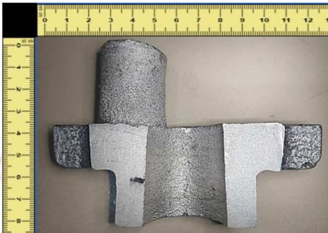
ภาพที่ 4-56 แสดงงานเทหล่อจริงของชิ้นงาน Cylinder_Q4 Riser ที่ผ่าเพื่อตรวจสอบเนื้อด้านใน
