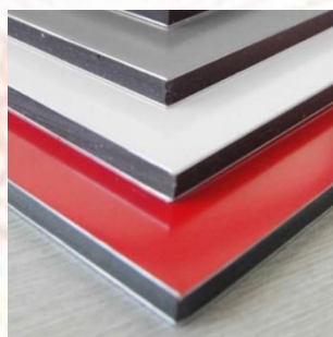
ภาพที่ 2-60 อลูมิเนียมคอมโพสิต (Aluminium Composite)
