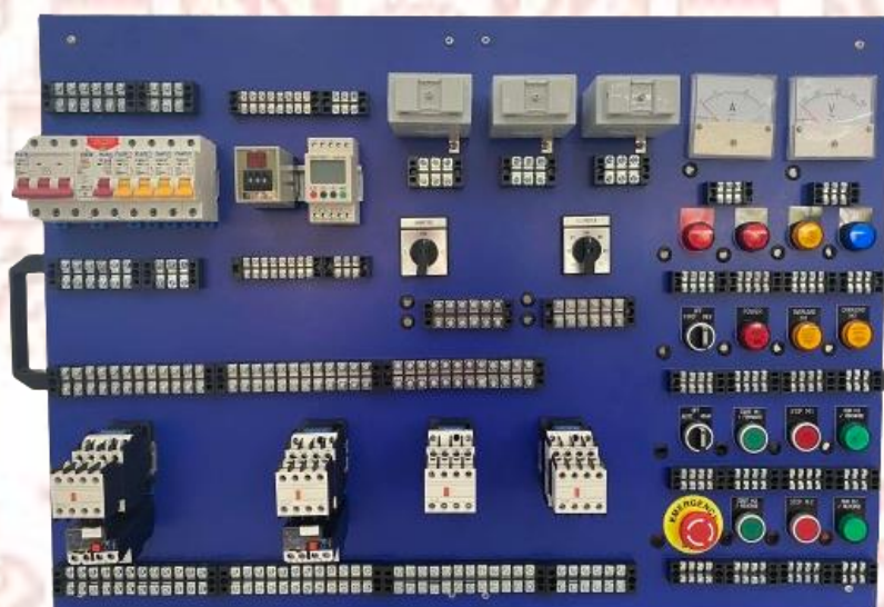
ภาพที่ ค-6 ติดตั้งอุปกรณ์สำหรับการควบคุมมอเตอร์เหนี่ยวนำสามเฟสระดับกลาง
