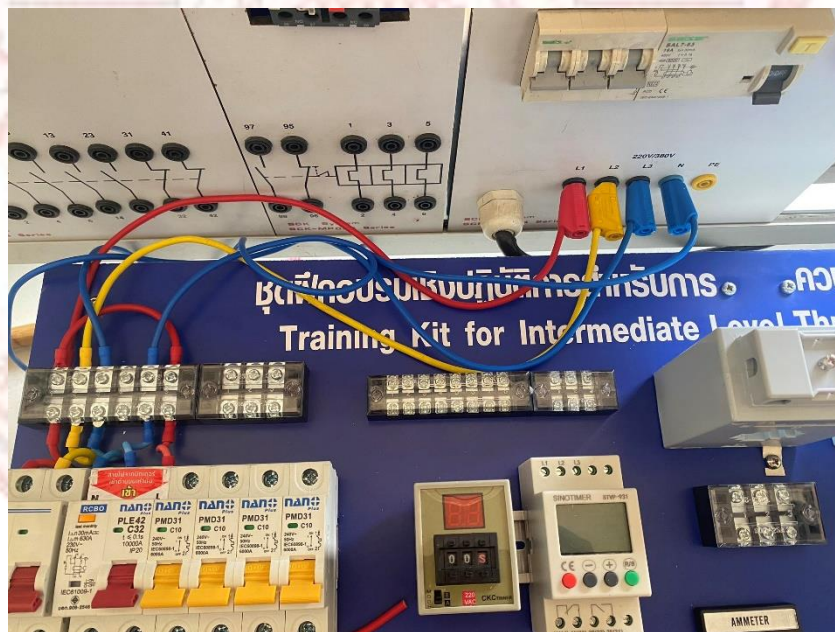
ภาพที่ ง-6 การต่อแหล่งจ่ายไฟฟ้าสามเฟสเข้ากับชุดฝึก
