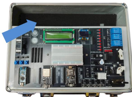
ภาพที่ 4-9 ตำแหน่งสำหรับเก็บอุปกรณ์เพิ่มเติม ขนาด กว้าง 6 cm., ยาว 31.5 cm. และสูง 7 cm.
