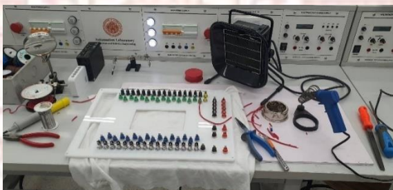
ภาพที่ 3-10 ดำเนินการวางตำแหน่งอุปกรณ์ลงบอร์ดด้านบน
