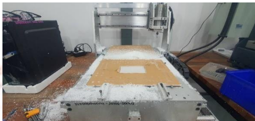
ภาพที่ 3-9 ดำเนินการใช้เครื่องกัด CNC เพื่อทำการกัดหลายตามที่ได้ออกแบบไว้
