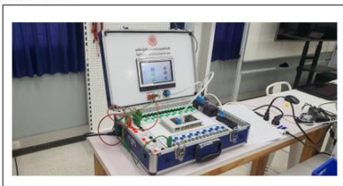
3.2 ภาพประกอบการต่อวงจรชุดฝึกปฏิบัติการระบบควบคุมอัตโนมัติ โดยใช้ PLC และระบบ Cloud SCADA
