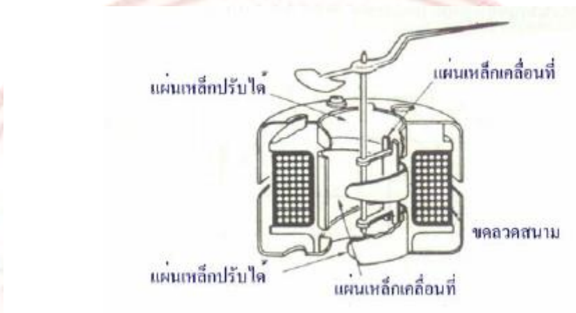
ภาพที่ 2-11 เครื่องวัดแบบแผ่นเหล็กเคลื่อนที่ใช้แรงดูดและแรงผลักร่วมกัน
