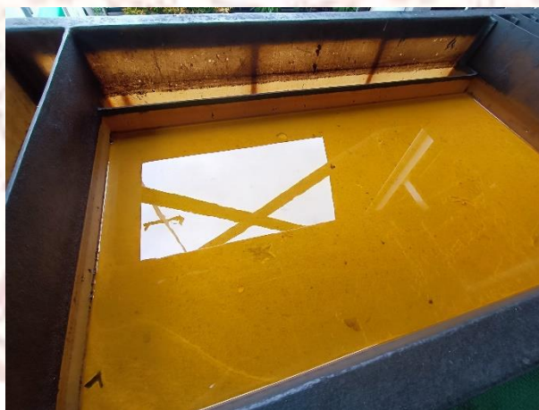
ภาพที่ 4-1 ตัวอย่างน้ำเสียจากกระบวนการล้างชิ้นงานแผ่นเหล็กของโรงงานผลิตที่ 2
