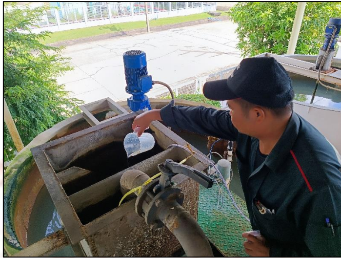
ภาพที่ 4-3 การเก็บตัวอย่างน้ำเสียเพื่อทำการตรวจวิเคราะห์ประจำวัน
