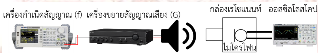
ภาพที่ 3-15 การทดลองวัดคลื่นเสียงความถี่ต่ำภายในกล่องเรโซแนนท์ (Resonant Cavity)
