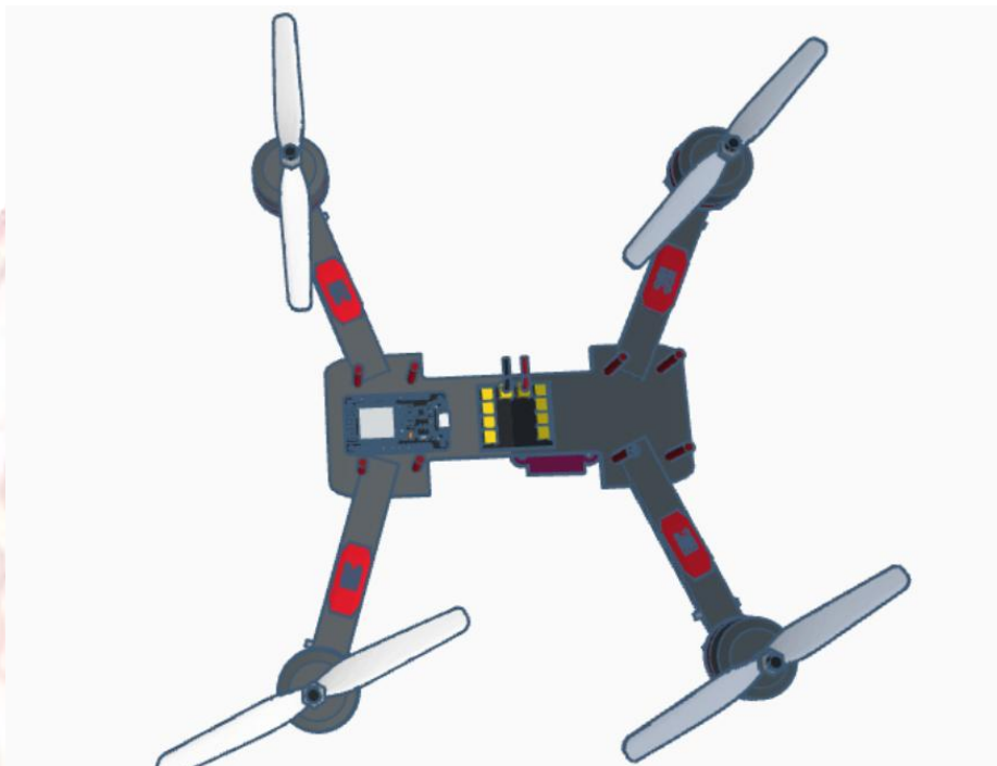
ภาพที่ ข-1 การออกแบบโครงสร้างอากาศยานไร้คนขับด้านบน
