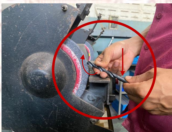
ภาพที่ 3-22 ขณะลับคมตัดมือข้างที่จับก้านดอกสว่านให้กดลงเล็กน้อยพร้อมกับบิดให้สว่านหมุน
