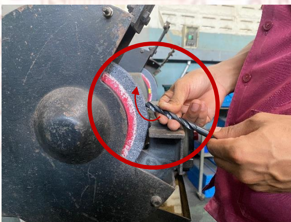
ภาพที่ 3-14 หมุนดอกสว่านไปจนถึงมุมหลบของดอกสว่านเท่ากับ 8-12 องศา
