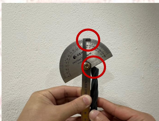
ภาพที่ 3-24 ตรวจสอบมุมของปลายดอกสว่านด้านที่ 2 เท่ากับ 59 องศา
