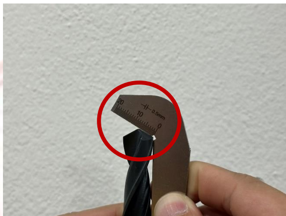
ภาพที่ 3-23 ตรวจสอบความยาวของคมตัดดอกสว่านด้านที่ 2 ด้วยเกจวัดดอกสว่าน
