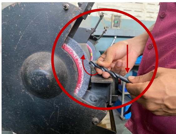
ภาพที่ 3-15 ขณะลับคมตัดมือข้างที่จับก้านดอกสว่านให้กดลงเล็กน้อยพร้อมกับบิดให้สว่านหมุน
