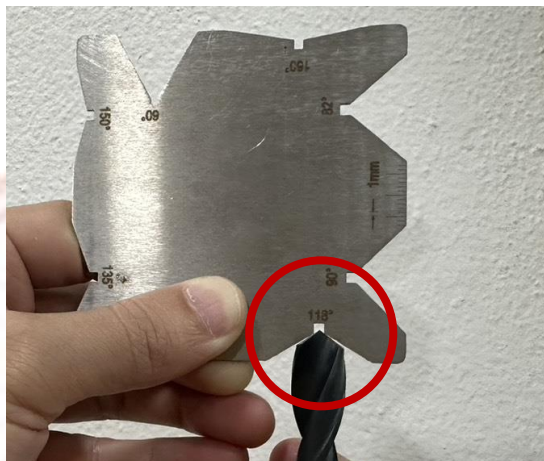
ภาพที่ 3-25 ตรวจสอบมุมรวมของปลายดอกสว่านเท่ากับ 118 องศา
