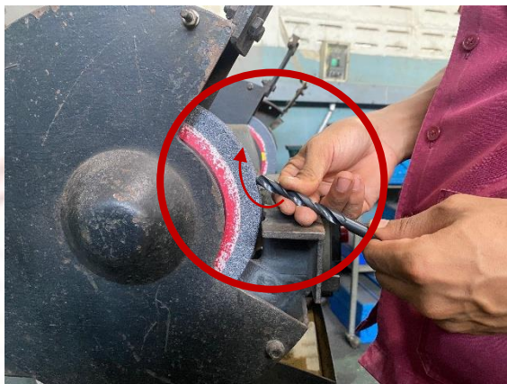
ภาพที่ 3-21 หมุนดอกสว่านไปจนถึงมุมหลบของดอกสว่านเท่ากับ 8-12 องศา
