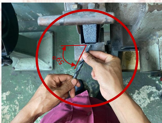
ภาพที่ 3-12 ดอกสว่านทำมุม 59 องศา กับผิวหน้าของล้อหินเจียระไน
