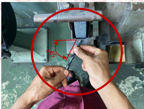
ภาพที่ 2-14 งานลับคมเครื่องมือตัดดอกสว่าน
