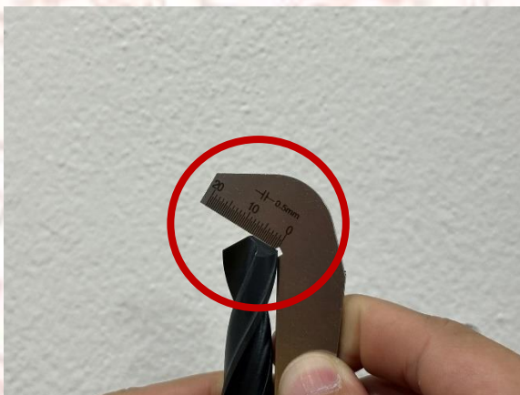
ภาพที่ 3-16 ตรวจสอบความยาวของคมตัดดอกสว่านด้านที่ 1 ด้วยเกจวัดดอกสว่าน
