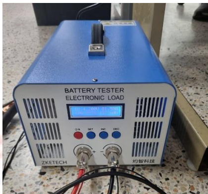
ภาพที่ 3-8 เครื่องวัดแบตเตอรี่ (Battery Tester)
