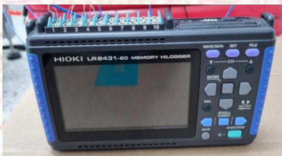
ภาพที่ 3-9 เครื่องบันทึกข้อมูลแบบอิเล็กทรอนิกส์ (Data Logger)
