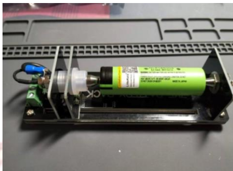
ภาพที่ 3-10 แท่นทดสอบแบตเตอรี่ทรงกระบอก (Cylindrical Battery Testing Fixture)
