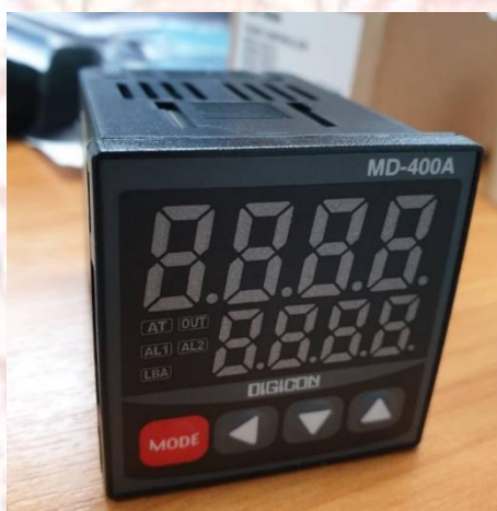
ภาพที่ 3-14 เครื่องวัด/ควบคุมอุณหภูมิแบบดิจิตอล
