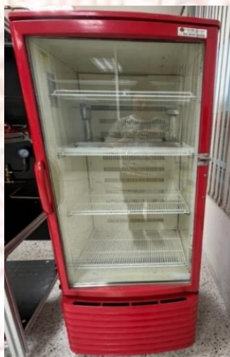
ภาพที่ 3-7 ตู้ควบคุมบรรยากาศ (Environmental Chamber)
