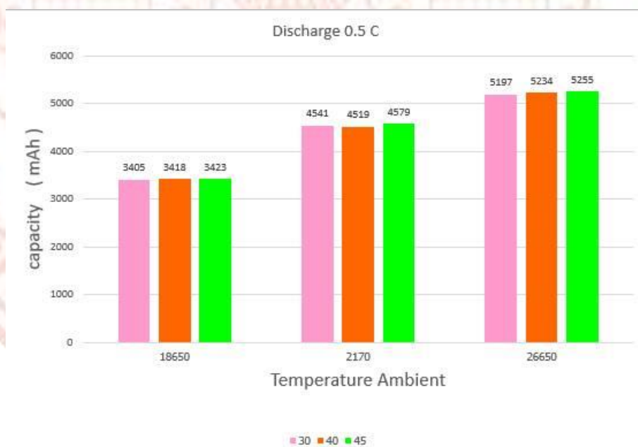
ภาพที่ ก-18 ผลกระทบของอุณหภูมิแวดล้อมต่อความจุของแบตเตอรี่ขณะคายประจุที่ 0.5 C
