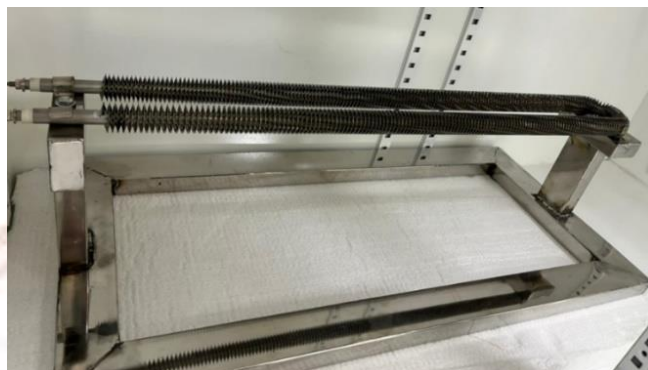
ภาพที่ 3-13 ฮีตเตอร์แบบครีบทัวยูขนาด 3,000 W
