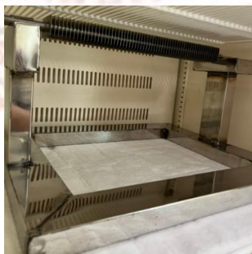
ภาพที่ 3-12 ฮีตเตอร์ครีบบแบบเหลี่ยมขนาด 600 W
