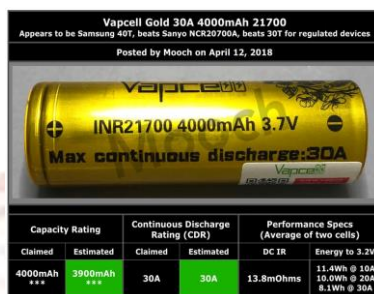
ภาพที่ 3-6 แบตเตอรี่ Lithium-ion ยี่ห้อ Vapcell โมเดล 2170
