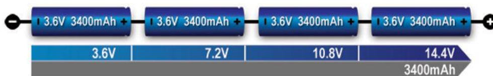
ภาพที่ 2-8 การเชื่อมต่อแบบอนุกรมของสี่เซลล์ (4s)
