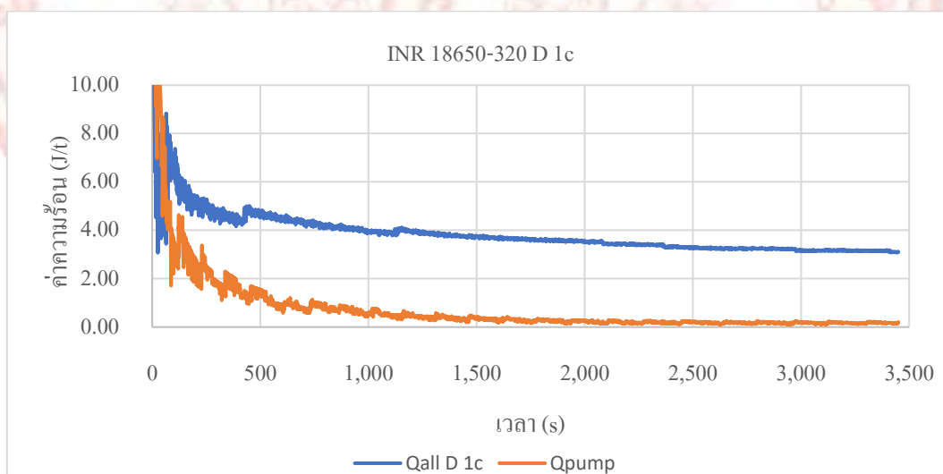
ภาพที่ ก-14 กราฟเปรียบเทียบอุณหภูมิทั้งระบบ และปั๊มของแบตเตอรี่ INR 18650-320 ในกระบวนการคายประจุ (Charge) ที่ 1c
