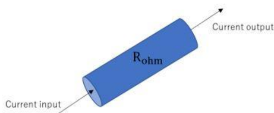
ภาพที่ 2-2 ภาพความต้านทานภายในเซลล์แบตเตอรี่
