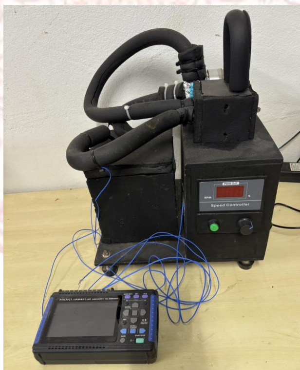
ภาพที่ 3-5 ชุดทดลองหาค่าความร้อนของแบตเตอรี่โดยใช้น้ำเป็นตัวกลางในการแลกเปลี่ยนความร้อน
