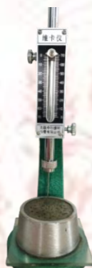
ภาพที่ 3-5 การทดสอบระยะเวลาการก่อตัวโดยเข็มไวแคต
