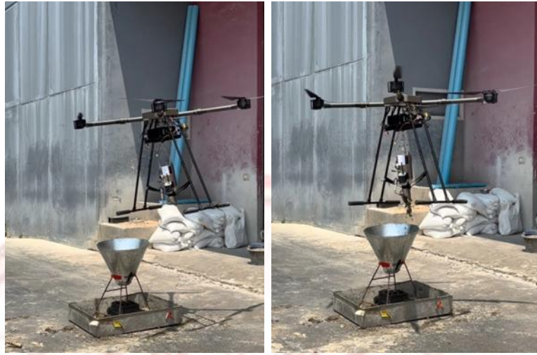
ภาพที่ 4-21 โดรนขณะเทคอนกรีตของแบบหล่อลูกบาศก์
