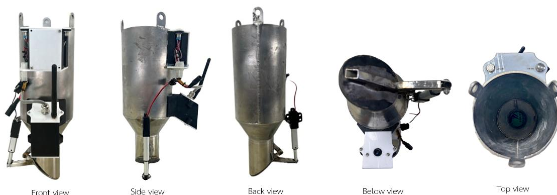
ภาพที่ ข-2 มุมมองของอุปกรณ์ถังเทคอนกรีตด้วยโดรน
