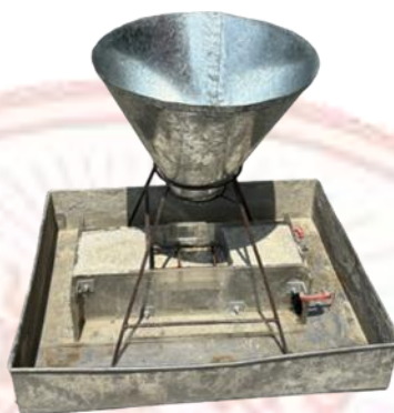
ภาพที่ 3-13 กรวยรองรับคอนกรีตจากการเทคอนกรีตด้วยโดรน
