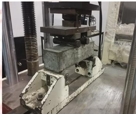
ภาพที่ 3-7 การทดสอบกำลังรับแรงดัด
