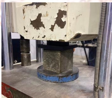
ภาพที่ 3-6 การทดสอบกำลังรับแรงอัด
