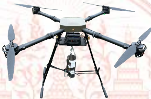
ภาพที่ ก-1 โดรนรุ่น Heavy-lift Quadcopter UAV
