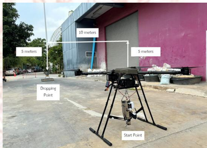
ภาพที่ 3-15 ทิศทางการบินโดรนโดยมีการเทคอนกรีตด้วยโดรน
