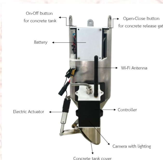
ภาพที่ ข-3 ส่วนประกอบของถังเทคอนกรีตสำหรับโดรน
