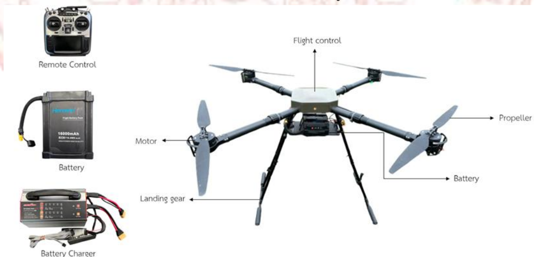
ภาพที่ 3-8 โดรนและอุปกรณ์ที่ใช้กับโดรน
