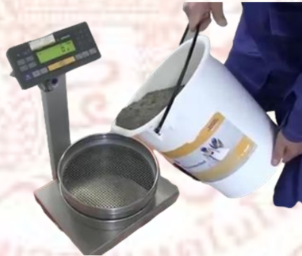
ภาพที่ 3-4 การทดสอบความต้านทานการแยกตัว (GTM screen stability test)
