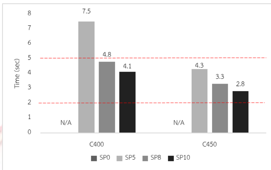
ภาพที่ 4-2 ค่าเวลาการไหลผ่านถึงระยะเส้นผ่านศูนย์กลางที่ 50 เซนติเมตร
