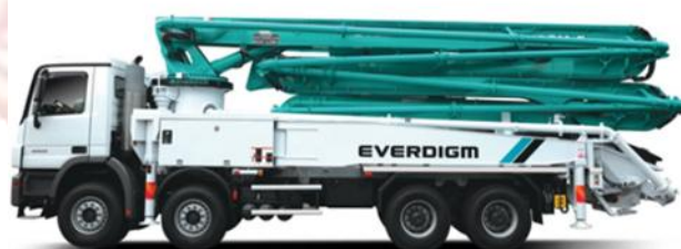
ภาพที่ 4-38 รถปั๊มบูมคอนกรีต EVERDIGM รุ่น ECP43 CX-5 [49]
