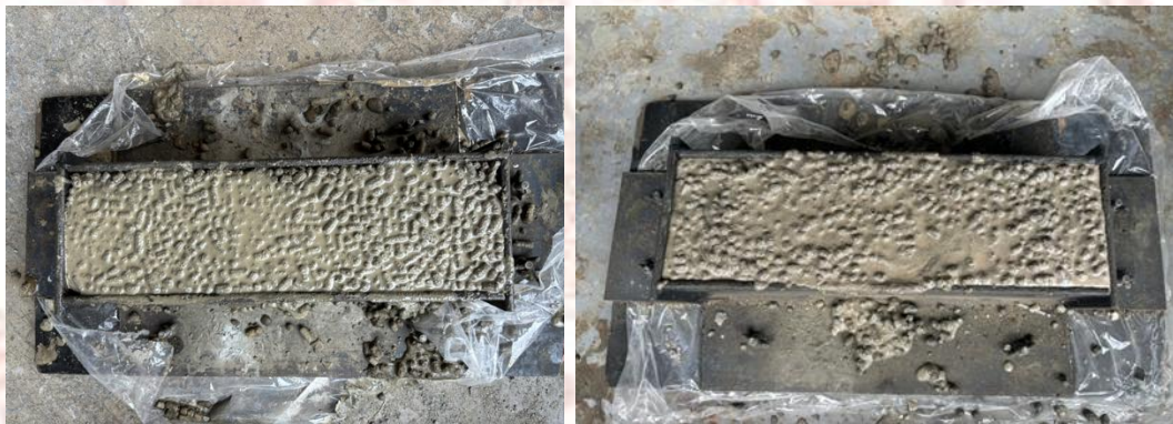
ภาพที่ 4-26 หลังจากการเทคอนกรีตด้วยโดรนในแบบหล่อคาน
